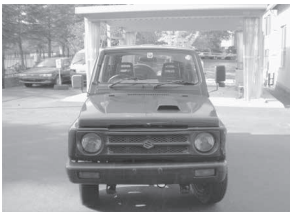
Fig. 2 コンバージョン EV 製作のためのベース車両 SUZUKI ジムニー (JA - 11V) 車両重量 900kg 3 A/T
