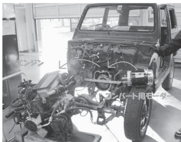
Fig.3 不要部品を取り外した車体
