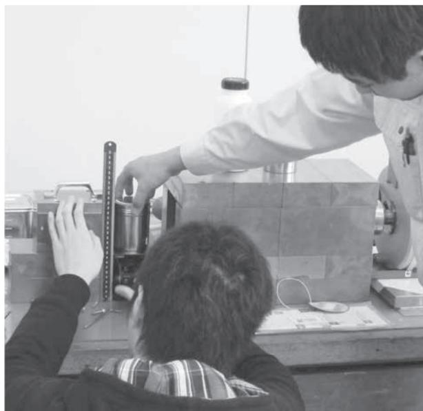
図5 放射線を利用したレベル計の基礎実験
