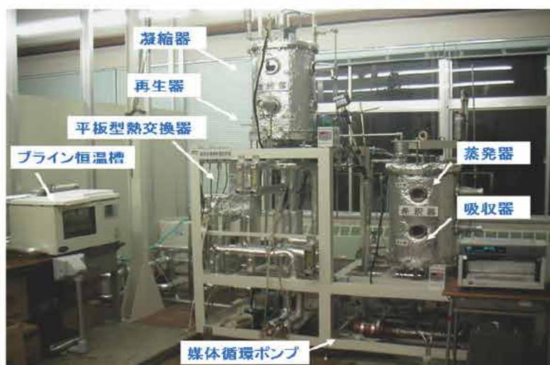
図1 吸収冷凍機の実験装置
