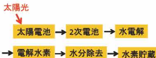
図3 太陽光を水素として貯蔵するシステム
