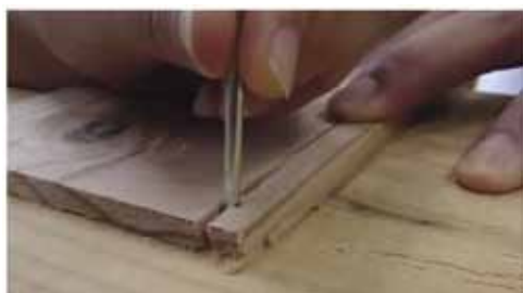
図1 釘打ちで板が割れる事例の動画
