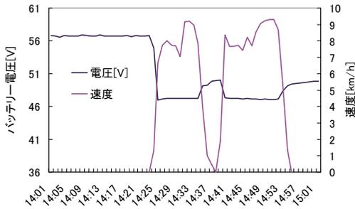
図7 バッテリー電圧と航行速度 (8月21日)
